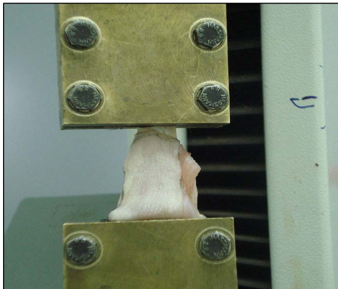
Figura 8- Fixação do corpo de prova – bloco
