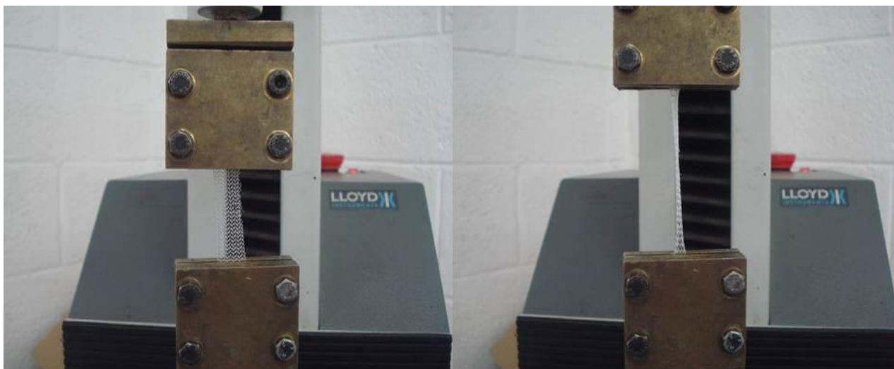
Figura 10. Testes de tração realizados com as telas, previamente ao implante. Sony DSC W 70, lentes 2,8-5.2
