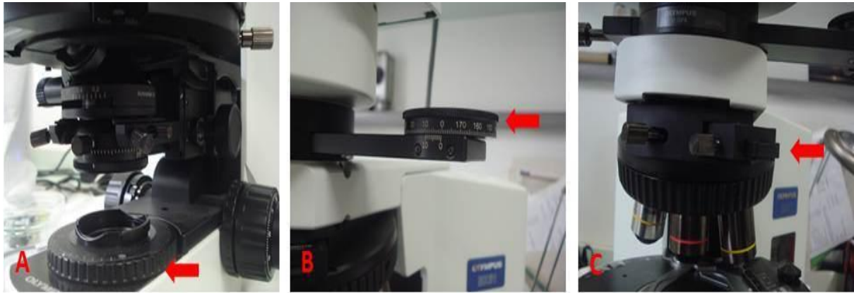
Figura 8. Microscópio de Polarização Olympus BX51, em detalhe, setas vermelhas. (A) Polarizador; (B) Analisador; (C) Compensador de Sénarmont
