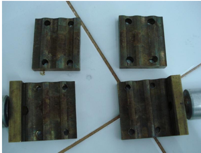
Figura 5. Sistema de ancoragem (presilhas) utilizado nos ensaios biomecânicos. Sony DSC W 70, lentes 2,8-5.2
